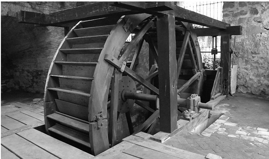
Реконструкция водяного колеса завода «Ла Росада», приводившего в действие мехи для доменной печи
