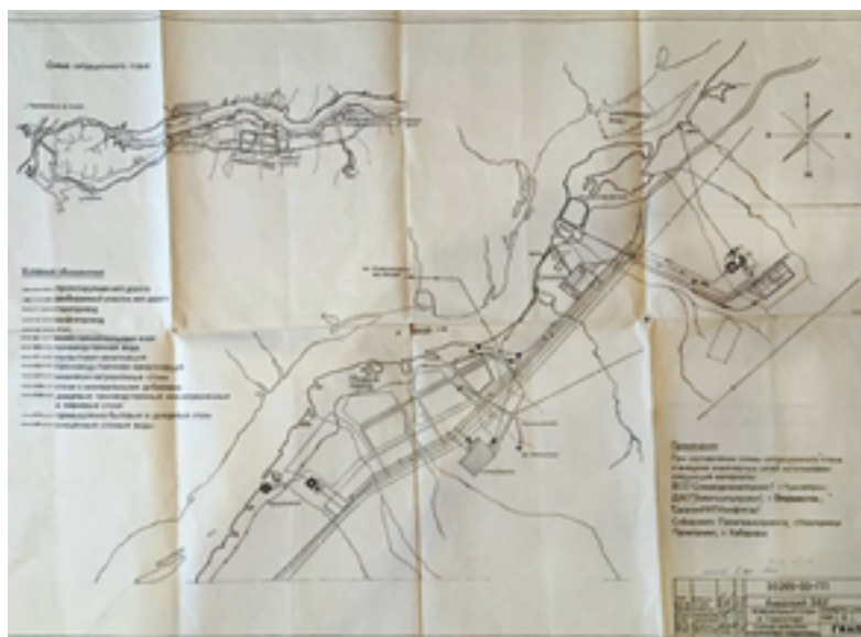
Схема размещения на местности Амурского завода азотных удобрений, план нового города, проектируемая железная дорога, ЛЭП и размещение других внешних инженерных коммуникаций
